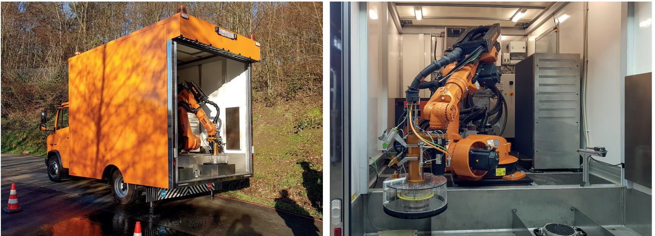
Bild 1 Messfahrzeug (Bild links) und Systemkomponenten (Bild rechts).
